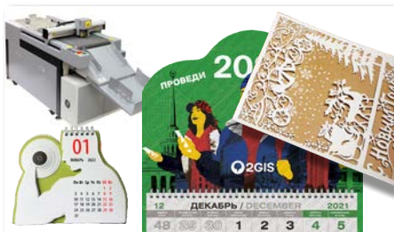
цифровой плоттер по бумаге (не требует изготовления штампа)
